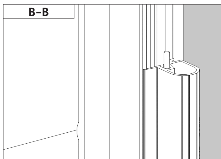
Схема прокладки кабеля обогрева в уплотнителе полотна.
