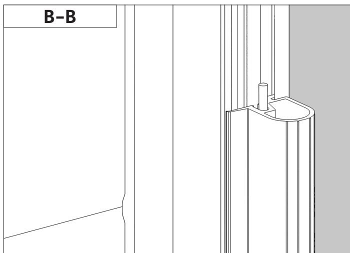
Схема прокладки кабеля питания в уплотнителе полотна.
