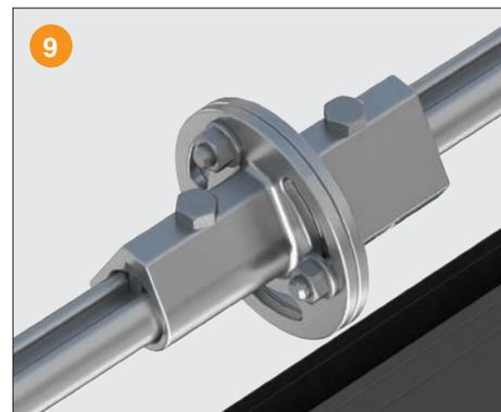
**Соединительная регулировочная муфта,** дает возможность вращать две части вала относительно друг друга, обеспечивая тонкую регулировку и правильное натяжение тросов, что значительно упрощает монтаж
