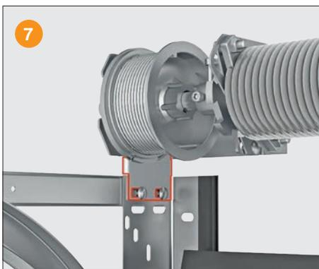
**Дистанционная пластина** уменьшает время монтажа и упрощает его. Позволяет точно установить место крепления п-образного кронштейна
