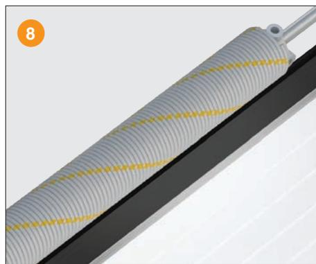
**Порошковое покрытие пружин.** Для улучшения механических свойств торсионные пружины проходят дробеструйную обработку и окрашиваются антифрикционным порошковым покрытием для защиты от коррозии.
